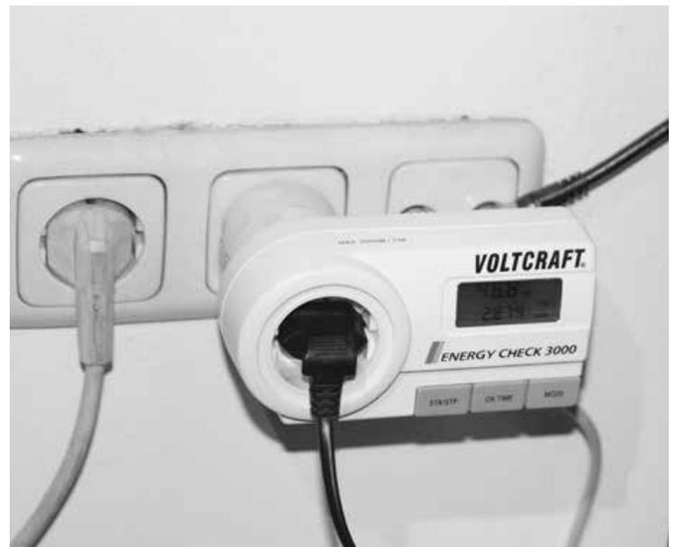
Mit dem Strommess-Gerät, welches man beim OÖ Energie-sparverband kostenlos ausborgen kann, wird der Stromverbrauch einzelner Geräte gemessen.
